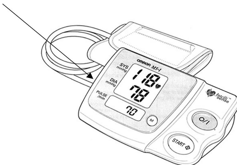
Slika 1: Izgled tlakomjera tip OMRON M5-I s prikazom mjesta za smještaj ovjerne naljepnice
